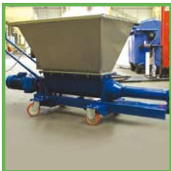
W-Pumpe zum Transfer von Fleischpüree
