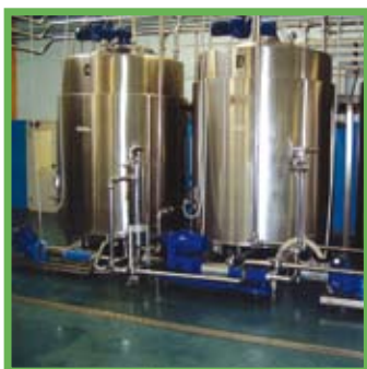
Hygienische Pumpe zum Transfer von Honig
