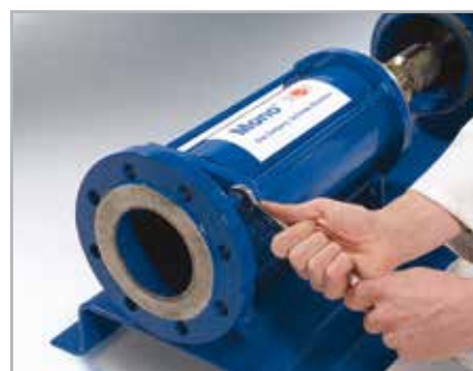
3. Zugstangen abschrauben und entfernen
