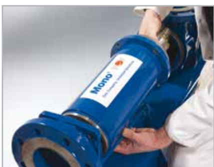
4. Rotor und Stator aus der Pumpe herausheben
