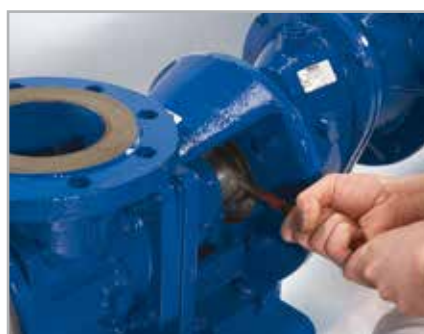
5. Schleuderringabdeckung zurückziehen und Stift aus dem Wellenstumpf herausdrücken
