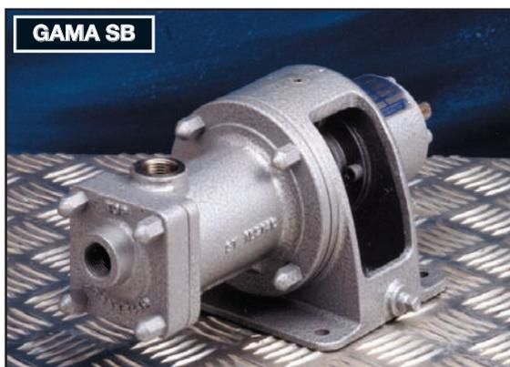
Las bombas Mono CB y SB aportan una solución económica a muchos problemas de bombeo, con su capacidad de hasta 600 l/h y presiones de hasta 2,76 bar. El sencillo diseño y construcción prolonga la vida útil de la bomba y requiere un mantenimiento rutinario único de la misma. La bomba CB se ofrece en diseño Monobloc® mientras que la SB incorpora diseño de alojamiento tipo cojinete.
