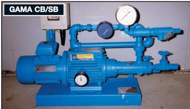
Esta bomba CS se usa para la dosificación de varias calidades de polielectrólitos en la industria del papel a caudales de hasta 500 l/h y presiones de hasta 2,5 bar. Esta bomba robusta y confiable fue desarrollada para satisfacer las características de funcionamiento específicas del cliente. Hasta la fecha, las bombas de esta gama han demostrado satisfacer por completo los requerimientos de este cliente.
