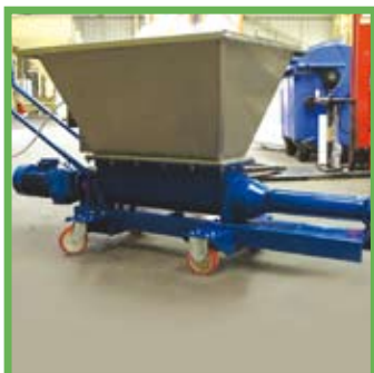
Pompe à grande ouverture transférant de la viande hachée
